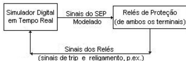
Figura 9: Teste em malha fechada da proteção
